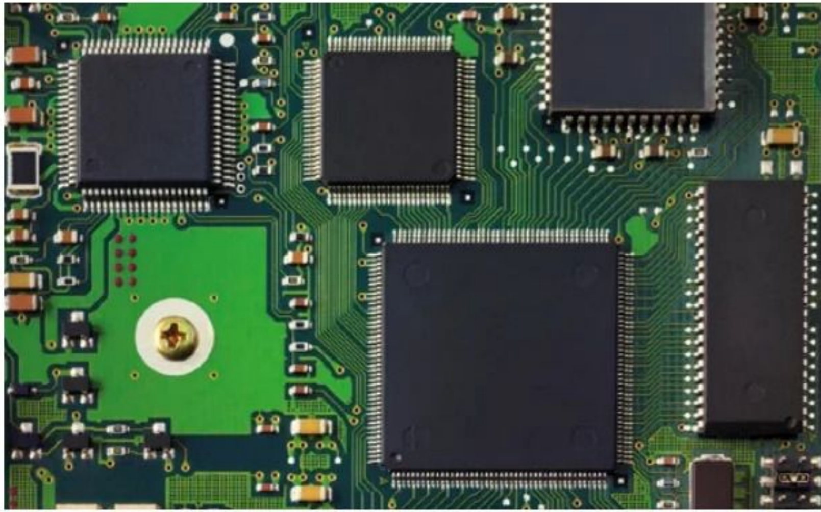
Un chip es un dado semiconductor compuesto de elementos electrónicos y conexiones internas, que permiten controlar la electricidad para tareas concretas.
