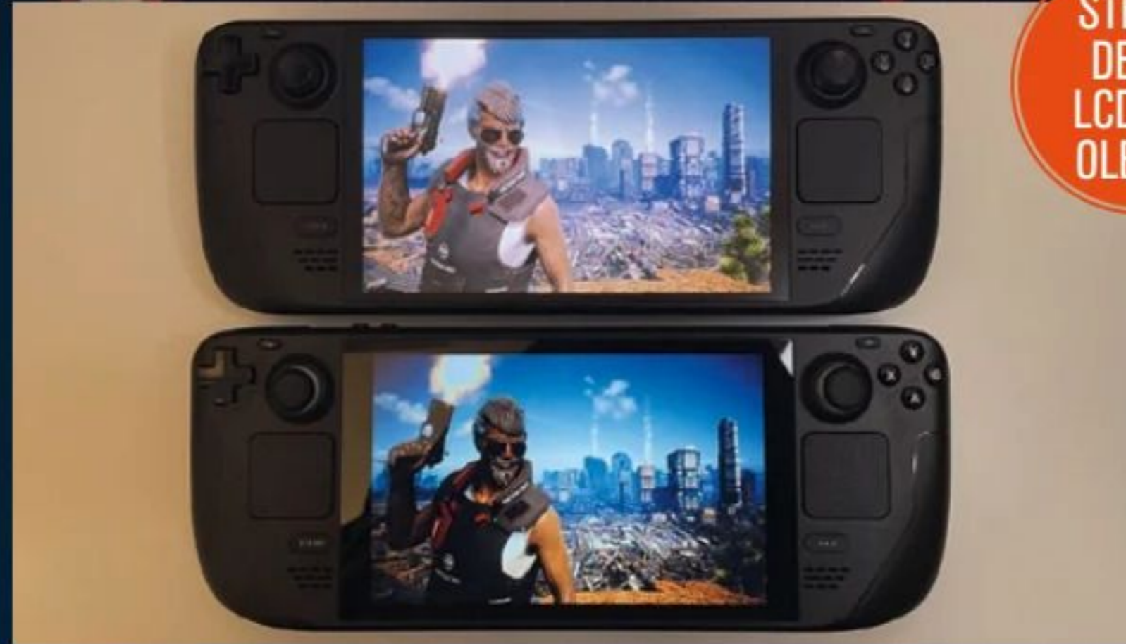
Steam Deck OLED (arriba) muestra los juegos de forma más brillante, con mayor contraste y con colores más ricos que la pantalla LCD.
